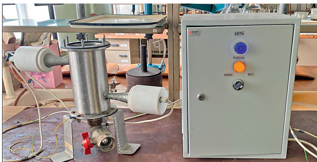
Рис. 2. Экспериментальный ультразвуковой реактор для обработки сточных вод
