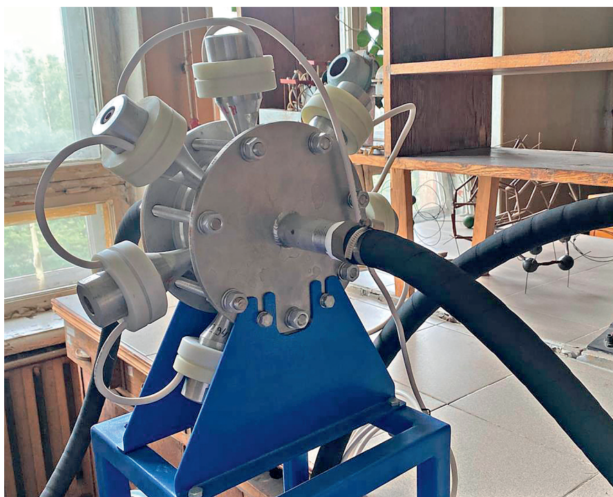
Рис. 3. Опытно-промышленный ультразвуковой реактор для обработки сточных вод
