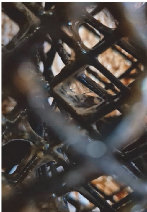
Рис. 2. Формирование биопленки в межъячеистых пространствах грузочного материала
